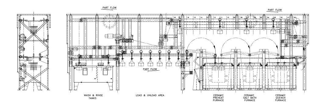
UPTON HIGH SPEED AUTOMATED SALT BATH FURNACE SYSTEM U-HS  $\,$
